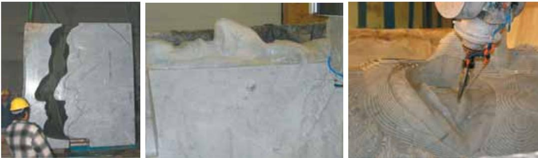
Nach dem Grobschnitt mit der Kontursäge übernahm die 5-Achs-HighTech CNC-Fräse der EEW in Kiel-Schönberg die Ausarbeitung des Kopfes (Fotos: Kai Dräger, Prometheus GmbH).
